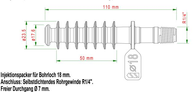
Injektionspacker (Lamellenschlagpacker) aus Hochleistungs- Kunststoff.
